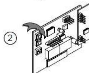
3) Нажмите кнопки T1 и T2 одновременно (в старых моделях скрытая кнопка P1) пока светодиод на приемнике не загорится постоянно.
