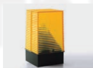
D113685 00001 – LAMPO AI 230V Сигнальная лампа, питаемая от 230В, со встроенной антенной. Антенный кабель 4 м только для радиоприемников с частотой 433.92 МГц
