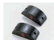
P111273 – CELLULA 130 Пара плоских самовыравнивающихся фотоэлементов для наружного применения, область распространения до 30м, 24В~(ac/dc)
