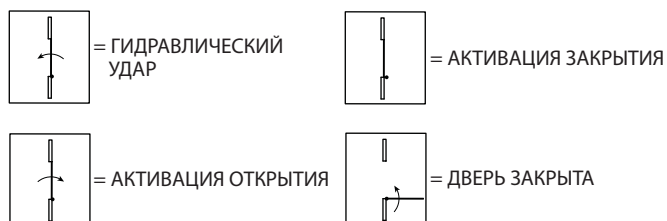
ЗАМОК С АКТИВАЦИЕЙ ПРИ ПОДАЧЕ НАПРЯЖЕНИЯ (Параметр 10=5)
